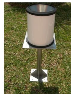
*Instalación Pluviómetro en suelo*
