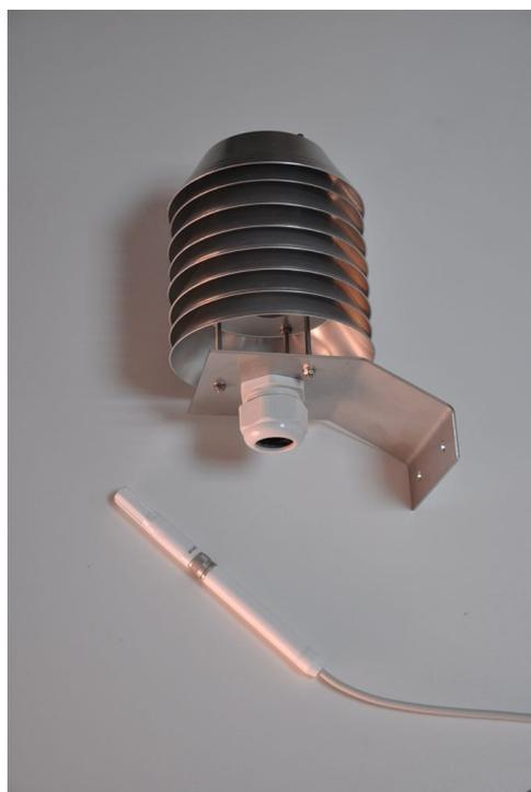
3.- Sonda de temperatura y Humedad con protector solar
