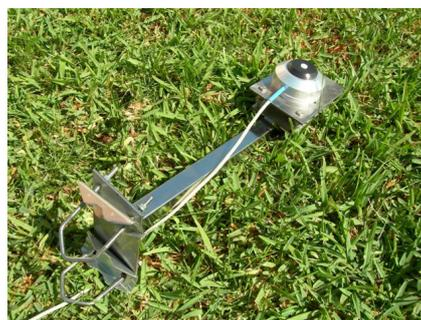
Los sensores que deban ir con inclinación, ya tendrán dicho ángulo incluido en el soporte o bien se suministrarán con un soporte horizontal, que se colocará solidario a un sistema inclinado (Tracker o seguidor solar)
