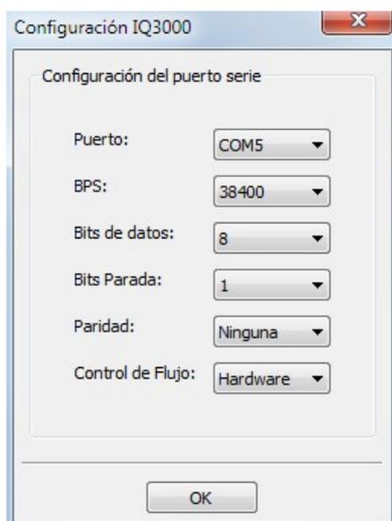
Localizado el número de puerto COM asignado por el PC a la conexión USB de la Estación Meteorológica, (Ver apartado anterior "Instalación Drivers") ya se puede configurar la conexión en el programa CONSOLA.
