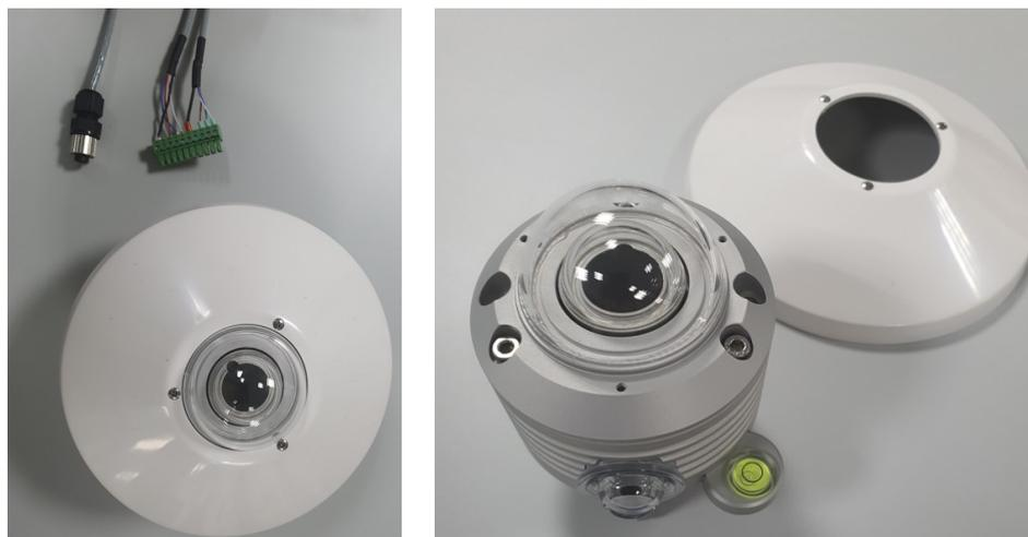
Para su instalación, se debe abrir el depósito de silica gel (Con una moneda por ejemplo) y rellenarlo. Tras esto, utilizando los tornillos pasantes, se debe fijar en su soporte nivelándolo.
