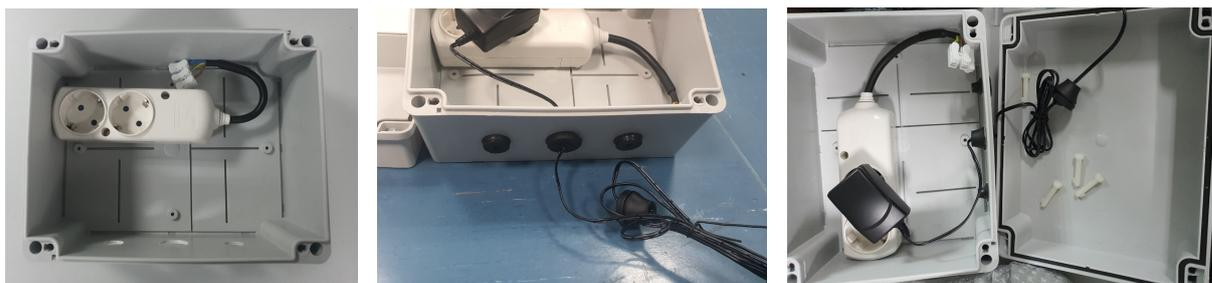
Cerrar la tapa de la caja intemperie con un giro en sentido horario de los 4 tornillos de cierre y ajustar la pletina posterior a la torreta de montaje de la Estación Meteorológica.
