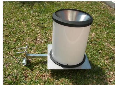
*Instalación Pluviómetro horizontal*
